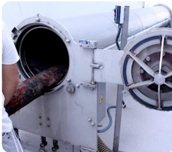
Esempio di tappeto inserito in una centrifuga per l'asciugatura.
